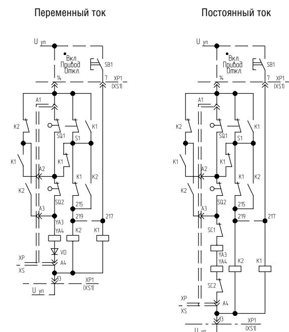
SQ1 — нажат при включенном выключателе,
