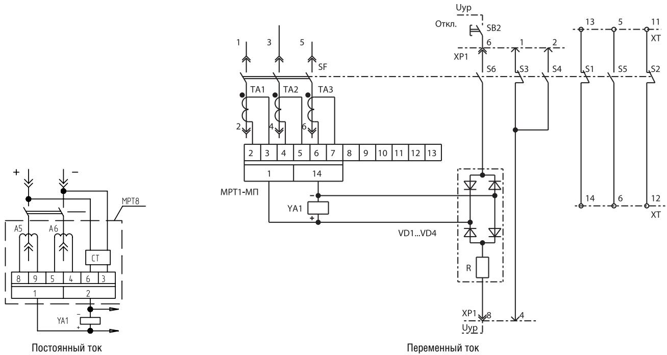
Рисунок Б.5. Схема электрическая принципиальная выключателей с электроприводом и независимым расцепителем стационарного исполнения
