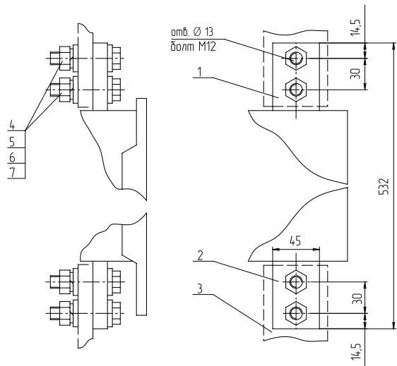
1 — вывод верхний; 2 — вывод нижний; 3 — присоединяемые шины;
