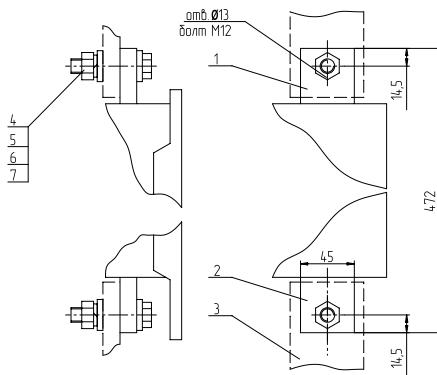
1 — вывод верхний; 2 — вывод нижний; 3 — присоединяемые шины;
