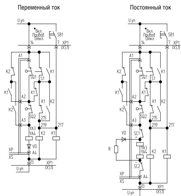
SQ1 — нажат при включенном выключателе,
