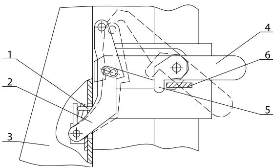
1 — шток; 2 — передаточный рычажный механизм; 3 — каркас;
